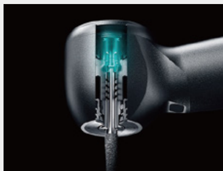
図2：DURAPOWER CHUCK。従来のチャックに比べ2倍の耐久性を発揮。把持力も大きく向上したため、バーのスリップや軸ブレのリスクを軽減できる。
