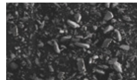
Perio Mate Powder(グリシン) 平均粒子径 25 μm SEM画像(×150)
