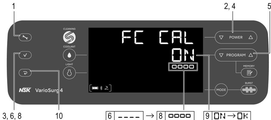
ワイヤレスフットコントロールのメインペダルやボタンは、経年劣化や部品の摩耗により反応が悪くなる場合があります。その場合は、以下の手順でキャリブレーションを行ってください。
