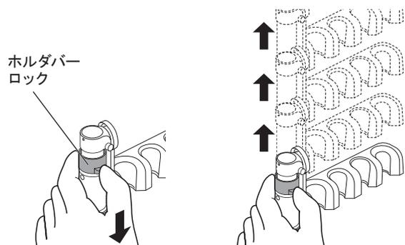
**6** ホルダアームロックを押して、ホルダを手前に回します。位置を4段階で設定できます。
