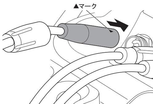
**2** プラグカバーを回して締め付けます。
