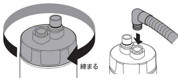
**7** バキュームノズルを一度取り外し、バキュームバルブに洗浄アダプターを取り付けてから、再度バキュームノズルを取り付けます。
