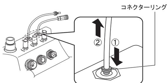
**2** 新しい注水プラグのチューブを突き当たるまで挿し込みます。その時、必ず透明色が右側、青色が左側になるようにしてください。
