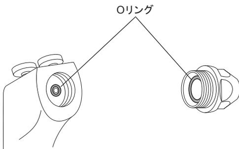
4 O リング受けをナットに取り付けてから、ナットをシリンジに取り付け、指で軽く締め付けます。
