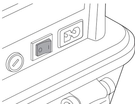
**2** 電源コードを先にインレットに奥まで押し込みます。後から商用電源コンセントに押し込みます。
