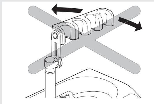
• ホルダに過度な荷重をかけないでください。破損、変形等の原因になります。
