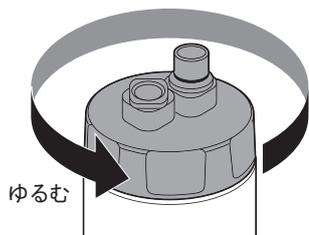
2 蓋からガイドを取り外します。VS 排唾ボトル用パッキン（黒）と蓋パッキンをピンセット等で取り外して新しいパッキンを取り付けます。
