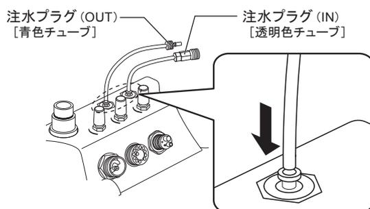
**3** チューブを押し引きして確実に取り付けられていることを確認します。
