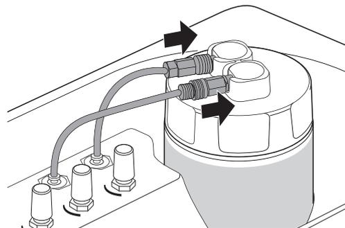
**6** バキュームボトルは、吸引物(唾液、血液等)を廃棄してから収納します。吸引物を廃棄せずに収納する場合は、バキュームボトルとバキュームホースにキャップを取り付けてください。
