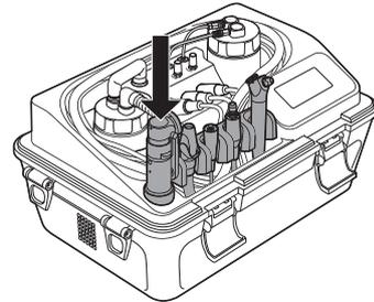
**10** コントロールユニットにトップケースを正しくセットし、バックル（4箇所）をロックします。
