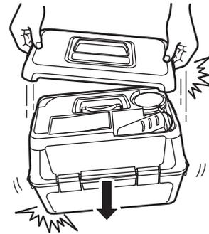
3 コントロールユニット前後にあるバックル (4箇所) のロックを外し、トップケースをコントロールユニットから取り外します。
