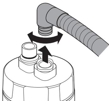
**5** バキュームボトルの蓋を取り外し、ボトル内部の吸引物(唾液、血液等)を廃棄します。
