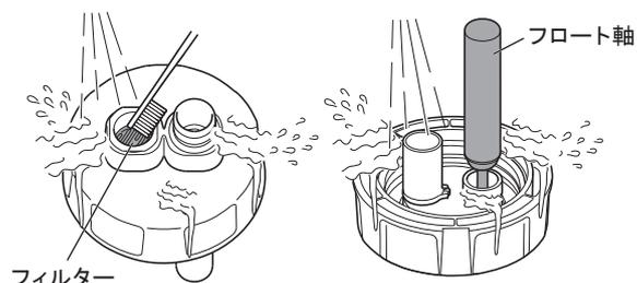
**5** バキュームボトルと蓋の外装および内部を流水できれいに洗浄します。
