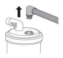
6 バキュームボトルの蓋を取り外し、ボトル内部の吸引物を廃棄します。
