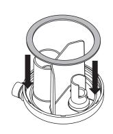
14 フロート本体およびフロート玉を取り付けます。
