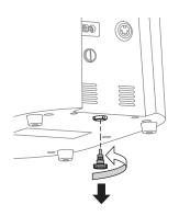
6 コントロールユニット内部の<u>吸引物が全て流れ出る</u> <u>まで</u>コントロールユニットを放置します。
