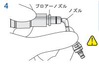
ノズルの先端にブロアーノズルを接 続しエアーのみで 空運転します。
